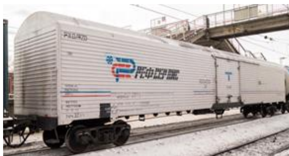
Рисунок 3. Вагон-термос изотермической модели 16-1807-04
