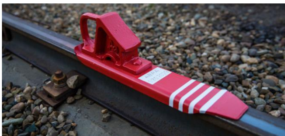
Рисунок 2. Современный тормозной башмак
