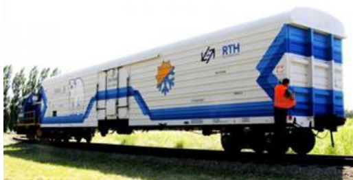
Рисунок 1. Вагон-термос модели 16-6962 для скоропортящихся грузов
