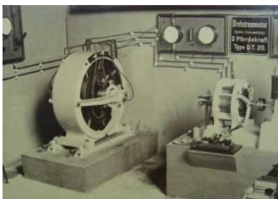
Рисунок 4. Трехфазный асинхронный двигатель Доливо-Добровольского
