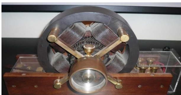
Рисунок 2. Модель индукционного (двухфазного) двигателя Н. Теслы
