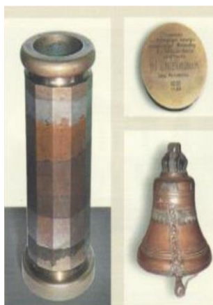
Рисунок 2. Стакан Славянова, сваренный из разных металлов
