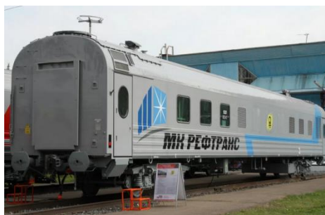
Рисунок 5. Вагон энергообеспечения группы крупнотоннажных рефрижераторных контейнеров
